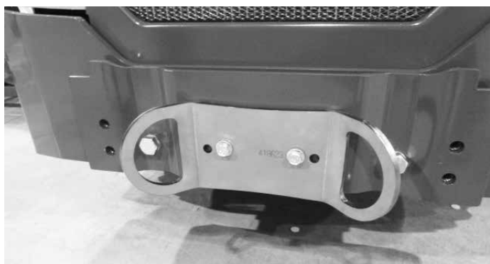
Priväzovacia konzola A418623 nainštalovaná na zadnom nárazníku alebo protizávaží
